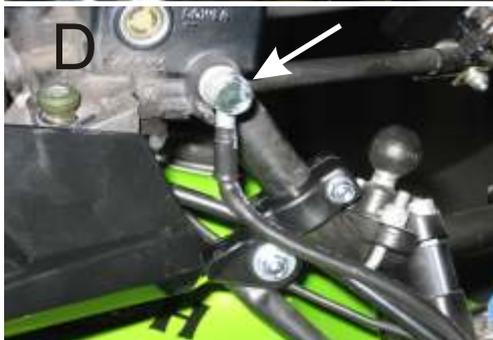
Bei den älteren Modellen muss evtl. Die Bremsleitung etwas verdreht werden. Dabei muss darauf geachtet werden, das keine Bremsflüssigkeit austritt. Schraube nur soweit lösen, das sie verdreht werden kann, danach die Schraube wieder anziehen, D.
