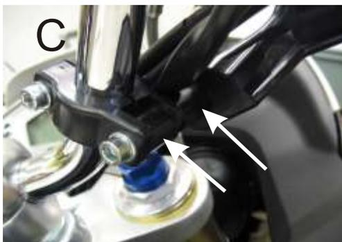
Positionieren Sie die Protektoren so, das Brems- und Kupplungshebel in ihrer Funktion nicht beeinträchtigt werden.
