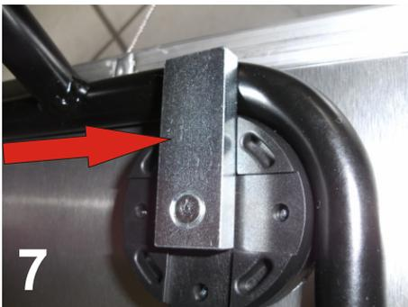
Jetzt den Riegel nach oben oder seitlich über den Rahmen drehen. Darauf achten, das der Riegel in der angebrachten Nut liegt. Jetzt den Alurändel im inneren des Koffers festschrauben und anschließend die Kunststoffmutter mit der Hand gegen den Alurändel schrauben.
