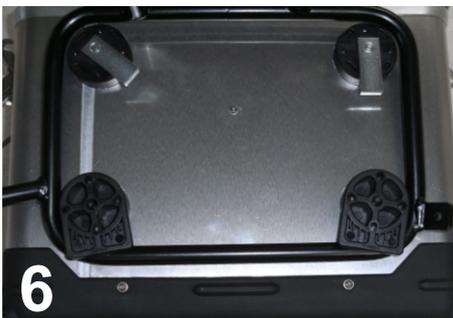
Drücken Sie mit dem Rändel die Verriegelung nach außen, bis diese frei beweglich ist und stellen Sie die Riegel nach innen.( Bild 6)
