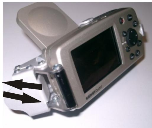
Um das Gerät in den Halter einzulegen ziehen Sie den Hebel nach außen bis an den Anschlag. Gerät mit ausgeklappter Antenne unter den rechten Haken schieben und mit leichtem Druck in die Halterung drücken. Jetzt Hebel loslassen und nach innen drücken, bis der Verschluss senkrecht zur Halterung steht. Bei abschließbaren Halterungen kann der Halter jetzt abgeschlossen werden.
